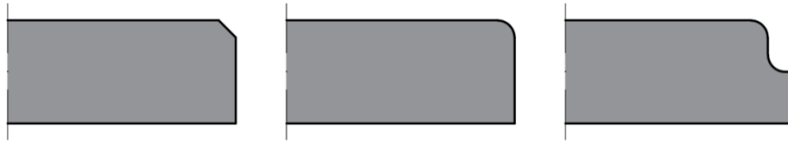
Figura 1.8 – Maquinação das arestas. Bisel, boleamento e fresagem.
