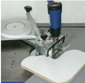
Ilustração: Colagem com uma folheadora “Kantenknirps” www.kantenknirps.de
